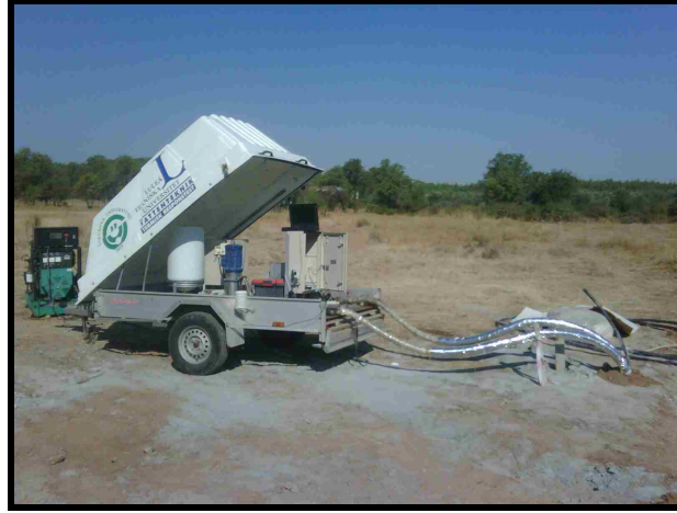
Resim 3: Muğla Bal Parmak Yeşil Bina Tesisleri TRT 1. kuyu ölçümünden bir görünüm
